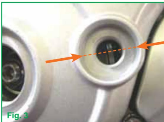
Ricercare la posizione corretta ruotando l'albero motore in senso antiorario servendosi del dado del rotore del generatore.
