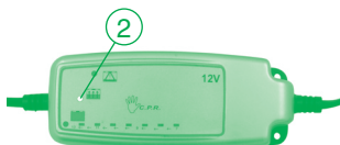
Figura (2) indica batteria da 12V e attualmente in carica
